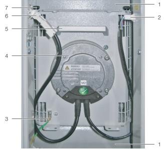
Fig. 40: Fan module in fan tray
