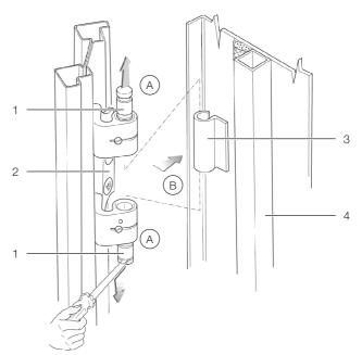
Fig. 17: Removing a door hinge
